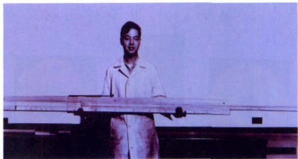
图10 1948年,费米和李政道手做的,为计算主序星内部温度分布专用计算尺。上边是 18\lg 下边是 6.5\lg
